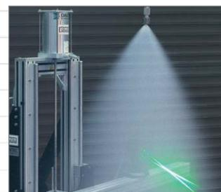
Unu dintre cele mai precise dispozitive pentru acest lucru este acest Analizator de Particule Doppler cu Laser. Deoarece aceasta metoda de masurare masoara simultan atat dimensiunea picaturii cat si viteza picaturi, am obtinut o descriere completa a caracteristicilor de atomizare. Deoarece lichidul atomizat nu dispare in picaturi de dimensiuni unifor-
